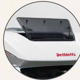
Großes, aufstellbares Fenster in der Fahrerhaushaube
