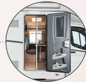
70 cm breite Aufbau-tür mit Fliegengitter-Jalousie (T 45)
