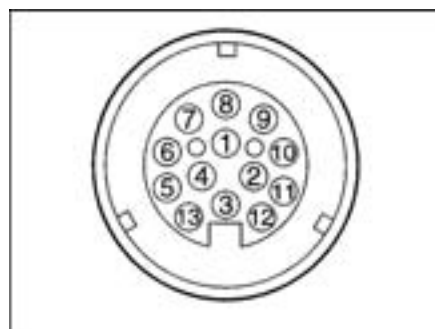
Bild 102 Sicht auf Steckdose Zugfahrzeug (dreizehnpoliges System Jaeger)
