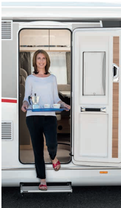
» 70 cm breite Aufbau-türe (außer T / I 1) mit Fliegengitter-Jalousie
