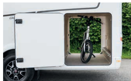
» Hohe, beidseitig beladbare Heckgarage mit 150 kg Flächenlast. Serienmäßig ausgestattet mit zwei Stauraumklappen
