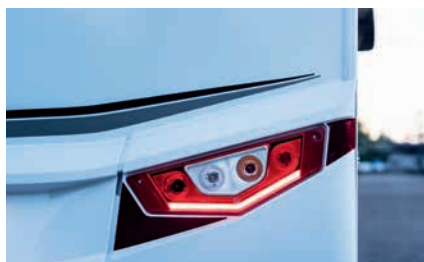
» T / I: Markant und sicher: Integral-Rückleuchten mit LED-Nachtfahrlicht
