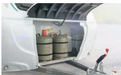
» Gasflaschenkasten für 2x11kg, Boden des Gasflaschenkastens aus verrottungssicherem, stabilem Aluminium-Riffelblech
