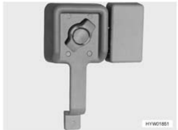
Bild 24 Türschloss, innen, verschlossen (Variante 1)
