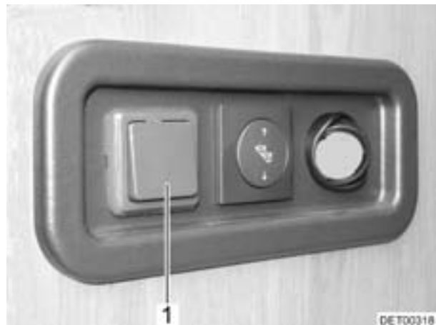
Bild 70 Lichtschalter Beleuchtung Einstieg
