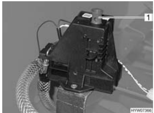
Bild 139 Sicherheits-/Ablassventil des Boilers
