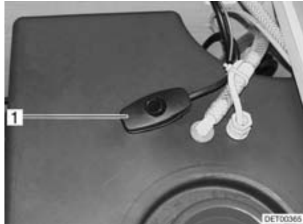
Bild 165 Schalter für Wasserpumpe
