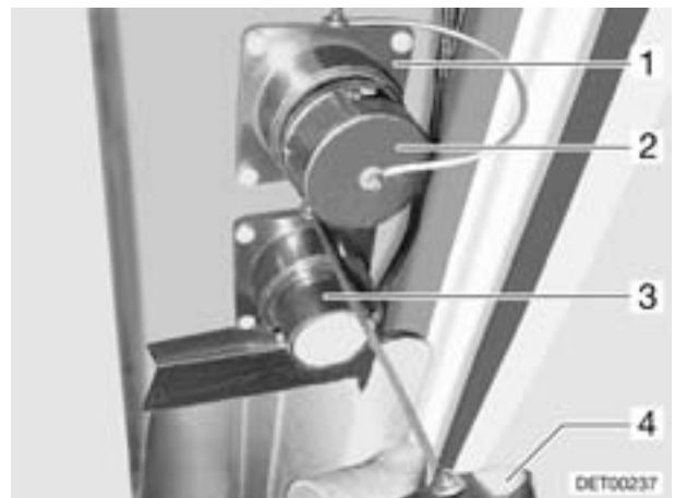
Bild 172 Wasser-Ablaufstutzen und Abwasser-Ablaufstutzen
