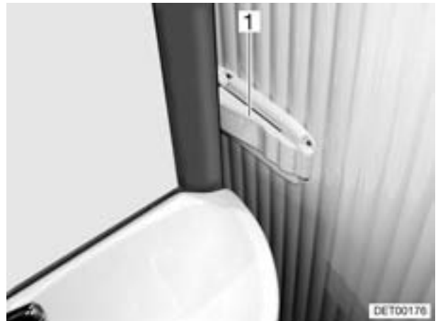
Bild 185 Vario-Toilette, Arretierung der Duschwand
