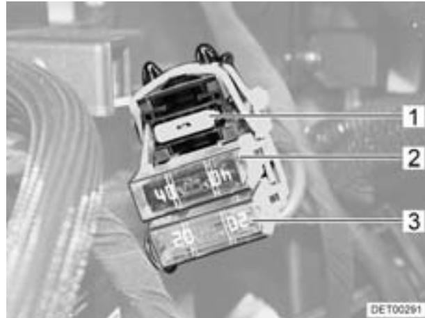
Bild 118 Sicherungen an der Starterbatterie
