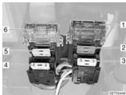
Bild 142 Sicherungen für die Starterbatterie (Fiat)
