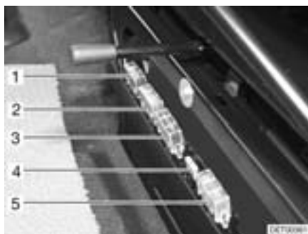
Bild 146 Sicherungen vor dem Fahrersitz (Ford)
