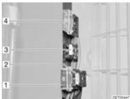
Bild 145 Sicherungen an der Wohnraumbatterie (Fiat)
