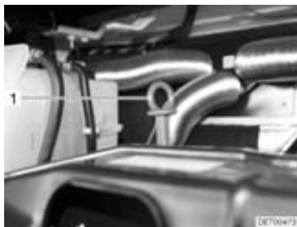
Bild 28 Öl-Mess-Stab (I-Modell)
