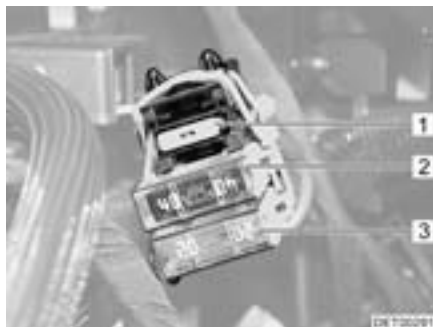
Bild 144 Sicherungen für die Starterbatterie (Renault)
