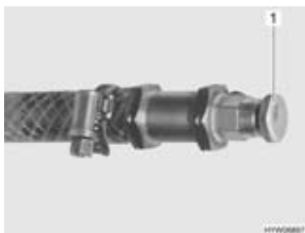
Bild 244 Entlüftungsventil Warmwasser-Heizung
