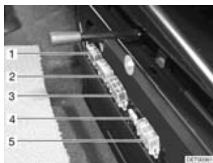
Bild 143 Sicherungen vor dem Fahrersitz (Ford)
