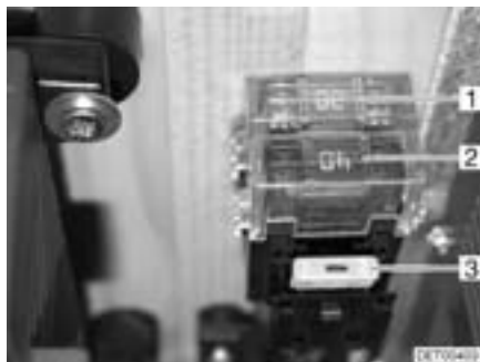
Bild 147 Sicherungen an der Wohnraumbatterie (Renault)
