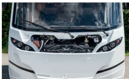
» I: Servicefreundlich: große Motorraumöffnung zur guten Erreichbarkeit aller service-relevanten Teile
