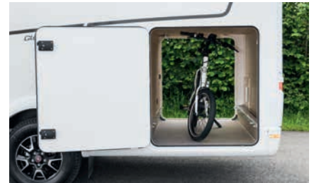
» Hohe, beidseitig beladbare Heckgarage mit 150 kg Flächenlast
