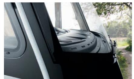
» Ein zusätzlicher Warmluftstrang der Aufbauheizung hält Front- und Seitenscheiben zuverlässig von Kondenswasser und Frost frei
