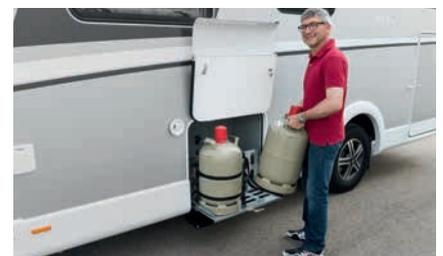
» Bequem: ausziehbarer Gasflaschenkasten für einen einfachen Gasflaschenwechsel
