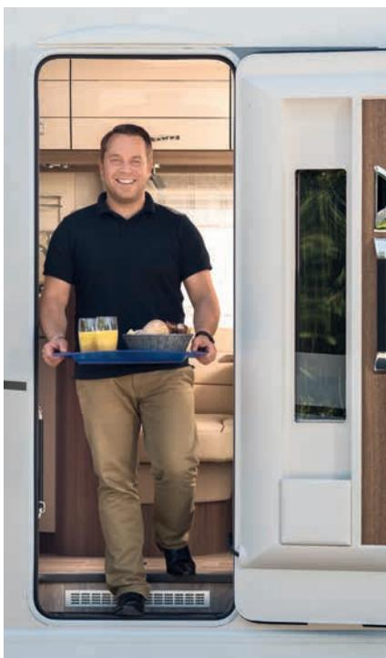
» Extrabreite Wohnraumtüre (70 cm) mit Zentralverriegelung, sicherer 2-Punkt-Verriegelung, Fenster und Fliegengitter-Jalousie
